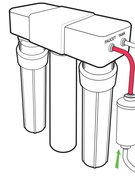
**6** Conecte el extremo restante de la manguera (que tiene el extremo opuesto conectado a la salida del colector de Ol etiquetado "Faucet" [Llave]) a la parte de entrada del remineralizador; para esto, presione la manguera hasta que se detenga.
