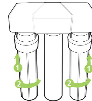
**7** Una vez que se hayan cambiado ambos cartuchos de filtro y se hayan instalado firmemente los sumideros en la carcasa superior, abra lentamente la válvula de agua fría. Confirme que la llave del sistema de filtración está cerrada y permita que el tanque se llene por completo (esto podría tardar alrededor de dos horas).
