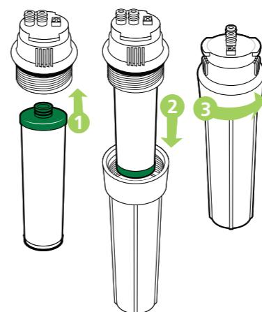
**6** Vuelva a fijar cada sumidero en la carcasa superior. Asegúrese de que todos los puntos de conexión estén alineados. Empuje la parte superior del sumidero hacia arriba y hacia el fondo de la carcasa superior y gire el sumidero hacia la derecha. Asegúrese de que el sumidero esté completamente instalado y bloqueado en la etapa 1 a la izquierda y en la etapa 3 a la derecha.
